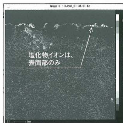
▲写真-2 海水噴霧試験3ヶ月結果 (EPMA試験)
