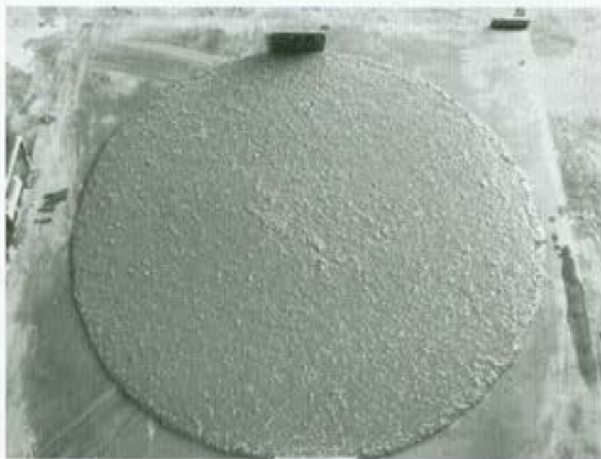
▲写真-1 高強度繊維補強モルタル
