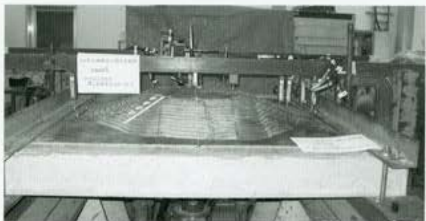
▲写真-2 NAV工法の耐荷性試験の状況
