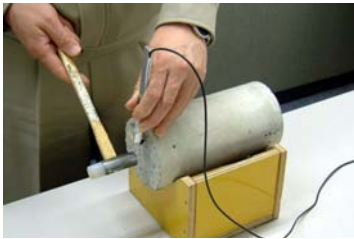
円柱供試体の弾性波速度測定状況
