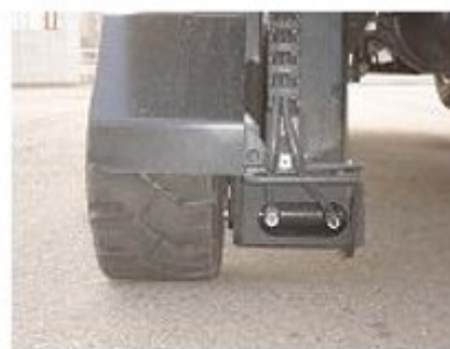
左右後輪駐車ブレーキ (油圧シリンダ式ピンブレーキ)
