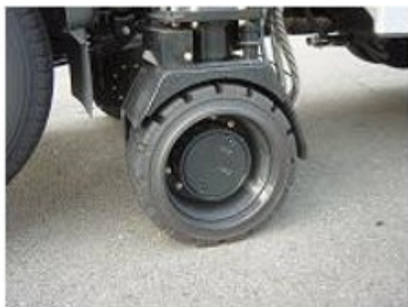
左右前輪駐車ブレーキ (油圧走行モーター内臓ディスクブレーキ)
