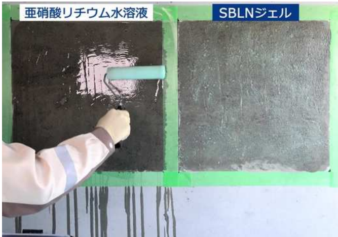
写真3 亜硝酸Li水溶液とのダレ性の比較
