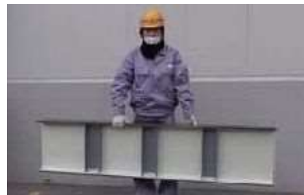
< FRP 横桁全景 >
