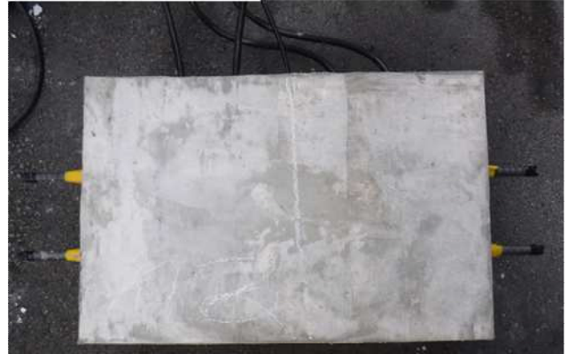
コンクリート供試体外観（右）および電極設置状況（左）
