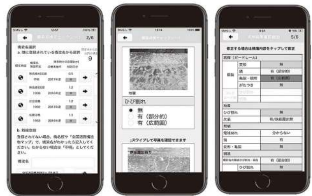
図-4 スマートフォンを用いた住民参加型橋梁点検システム「橋ログ」
