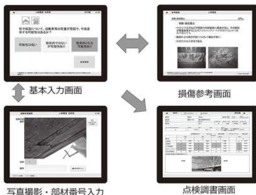
図-3 令和6年点検要領対応の小規模橋梁タブレット点検システムの画面例
