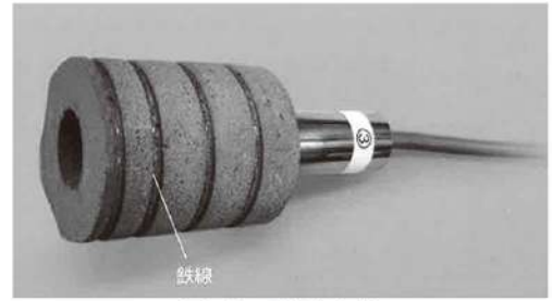
図-3 腐食センサ
