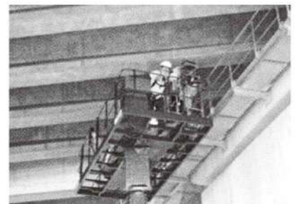
図-6 RANS-μによる塩分濃度測定状況
